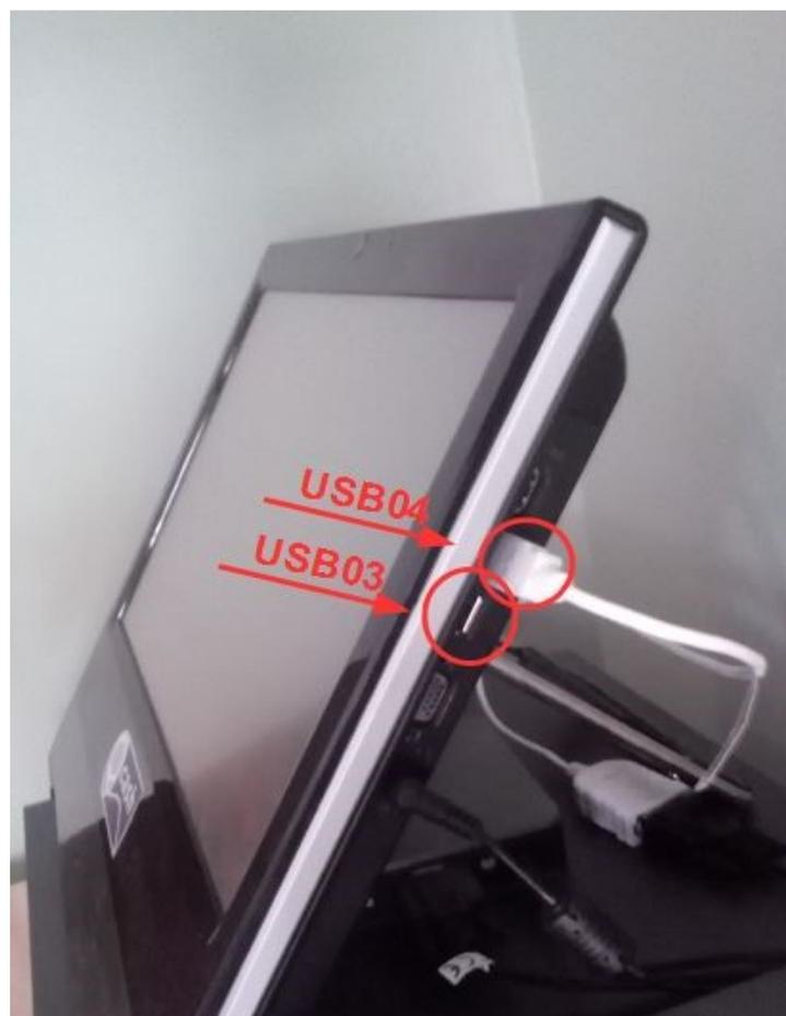
Le Module de Contrôle Fiscal doit être connecté au port USB04 au moyen de l'adaptateur TrendNet USB/Port Série fourni lors de l'installation.
