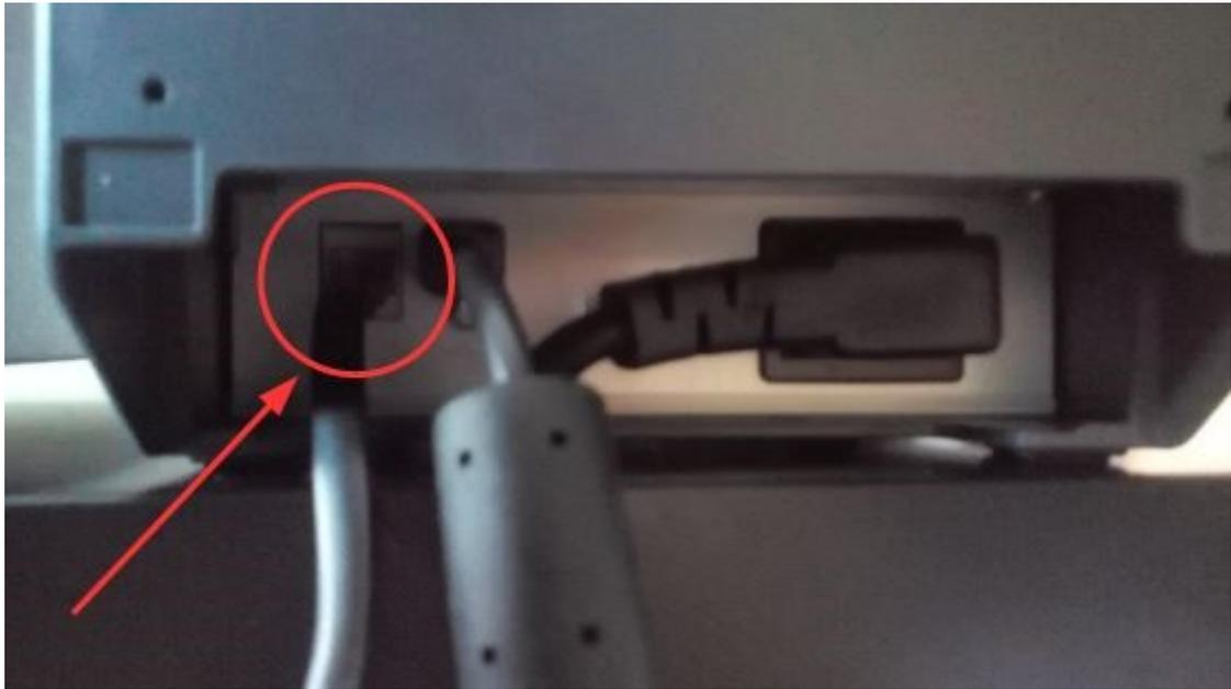
Afin de garantir un fonctionnement optimal, Qcash doit être raccordé directement au modem du client par câble Ethernet. Sur le modèle Z50C, le port Ethernet se trouve à l'arrière, dans la partie inférieure (voir image ci-dessus de disposition des ports du modèle Z50C) . Sur le modèle X50C, il est situé juste au-dessus du port USB02 (voir image ci-dessous).
